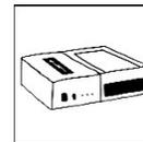
Indurimento degli oggetti stampati nell'Otoflash G171 (ottica NK) o in un dispositivo identico con 2 x 2000 flash in atmosfera di gas protettivo (azoto).
