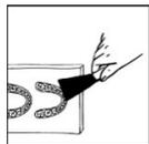
Rimuovere i manufatti stampati finiti e da qualsiasi residuo polimerizzato dalla piattaforma di costruzione con una spatola.
