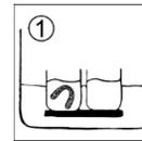
Pulire gli oggetti stampati in un recipiente separato con SHERAultra-p per un massimo di tre minuti in un bagno ad ultrasuoni. Spazzolare delicatamente aperture, fori e spazi vuoti con uno spazzolino morbido.
