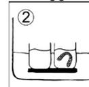
Pulire gli oggetti stampati in un recipiente separato con SHERAultra-p fresco per un massimo di tre minuti in un bagno ad ultrasuoni (tempo totale non superiore a 10 minuti!). Per asciugare, soffiare accuratamente i componenti con aria compressa.
